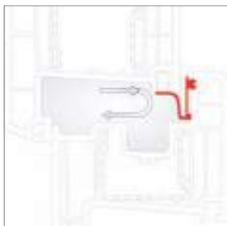
La creșterea presiunii vântului sistemul REHAU AirComfort se închide automat, pe baza principiului lui Bernoulli.
